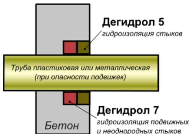
1. Односторонняя гидроизоляция ввода
